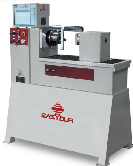
Questo torsiometro è dotato di computer con touch screen per l'esecuzione delle ricette di prova. Disponibili modelli da banco o autoportanti da terra.
