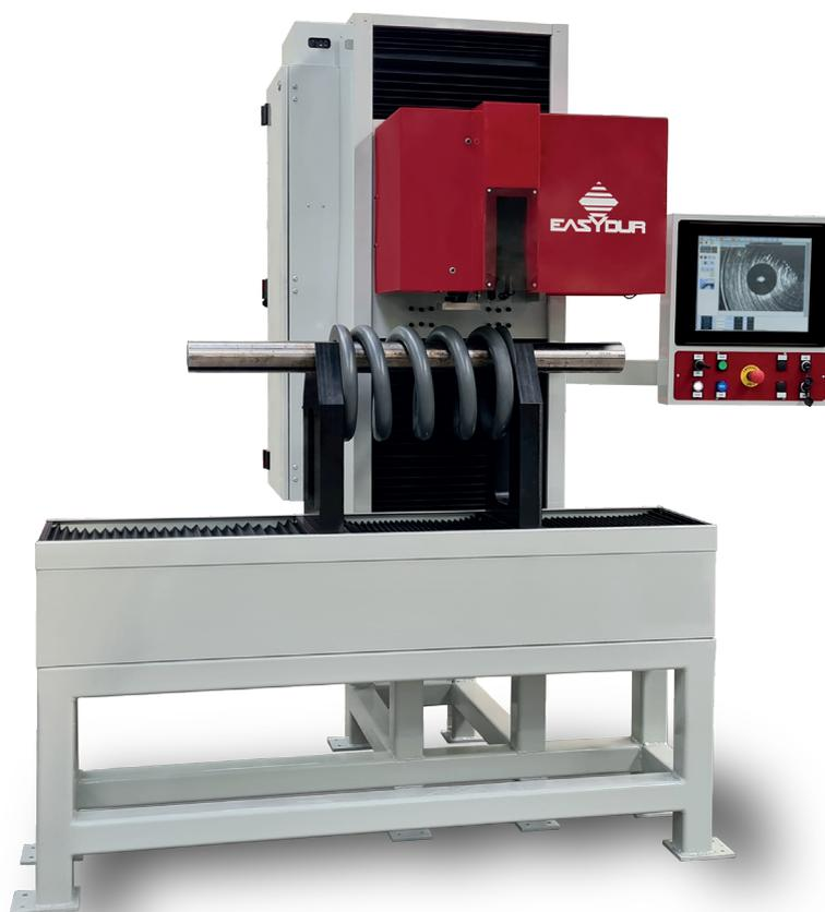
**Integral Springs** est un duromètre équipé d'une tête Multi-slot à fraisage intégré, adapté aux hautes et très hautes cadences de production sur des pièces délicates telles que les bouteilles - ressorts, sur lesquelles le fraisage de la préparation superficielle ne doit pas présenter d'angles vifs mais doit être arrondi.
