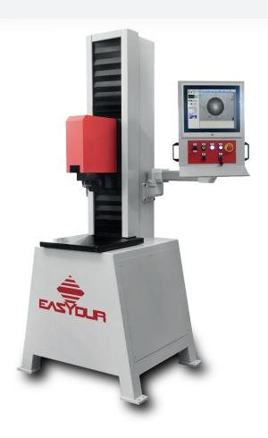
Integral Universal è uno dei modelli più versatili che Easydur produce, ed è perfetto per quelle situazioni che richiedano un durometro universale, in grado di eseguire svariati tipi di prove senza la necessità di smontare e rimontare accessori, lenti e penetratori. Viene costruito in due versioni: una con carichi da 1 a 250 kg, ed una più potente capace di eseguire prove di durezza con carichi dai 10 ai 3000 kg.
