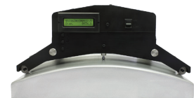
Roue interfaçable avec mesureur de profils et de diamètres
