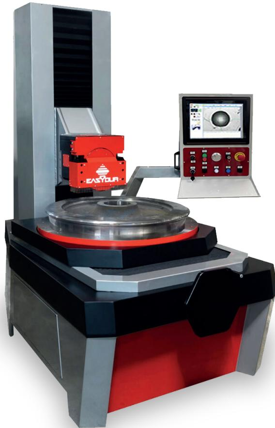
Integral Rotary ha sido diseñado por Easydur como un **durómetro de producción**, y puede considerarse una isla de trabajo ya que está equipado con un eje de ensayo y una mesa giratoria adicional, además de un segundo eje Y para mover la mesa giratoria adelante y atrás con respecto al cabezal.
