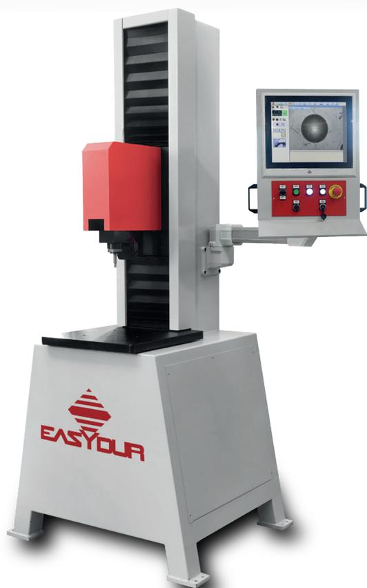
**Integral Universal** - это самый простой по концепции твердомер, производимый Компанией Easydur, он идеально подходит для ситуаций где требуется универсальный твердомер, который в состоянии проводить различные типы испытаний без необходимости снимать и устанавливать дополнительные устройства, линзы и пенетраторы. Производится в двух вариантах: один с нагрузками от 1 до 250 кг, и другой, более мощный, на котором можно проводить испытания с нагрузками от 10 до 3000 кг.
