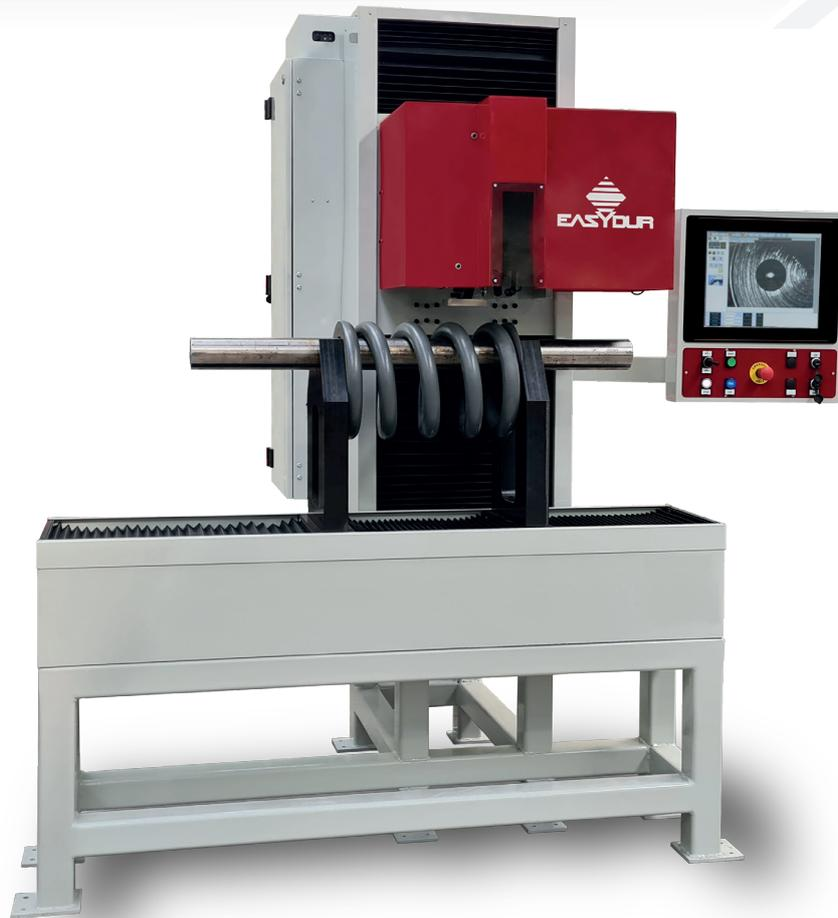
**Integral In Line** ist ein Härteprüfgerät, das mit einem Mehrschlitzkopf mit integriertem Fräser ausgestattet ist. Es eignet sich für hohe und sehr hohe Produktionsraten bei empfindlichen Werkstücken wie Federn, bei denen durch das Fräsen zur Oberflächenvorbereitung keine scharfen Kanten entstehen, sondern abgerundet werden müssen.
