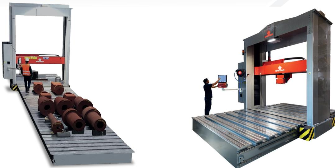
EASY 3000 – это портал измерения твёрдости для испытаний по Бринеллю и Роквеллу, разработанный специально для испытаний на кованых заготовках среднего, большого и очень большого размера. Эта машина предназначена дляковки и термообработки, где требуется проводить испытания на твёрдость на необработанных деталях различной формы, где сложно использовать стандартные измерители твёрдости по причине габаритов.
