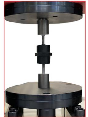
Je nach dem durchzuführenden Versuch, kann das Gerät mit verschiedenen **Zubehörteilen** ausgestattet werden: Platten, Karabinerhaken, Drahtzangen und **Spezialausrüstungen** gemäß den unterschiedlichsten technischen Spezifikationen, die von den internationalen Prüfnormen gefordert werden.
