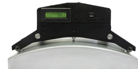
Rad, das mit Profil- und Durchmesser-messgerät verbunden werden kann
