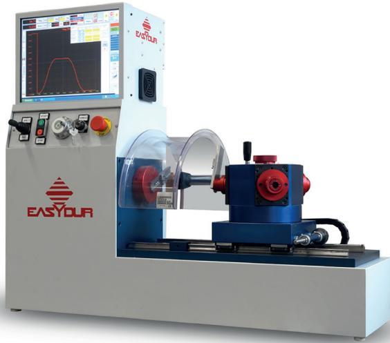
Das Torsiometer ist mit einem PC mit Touch Screen zur Ausführung der Test-Rezepte ausgestattet. Es ist in der Werkbank- und in der freitragenden Bodenausführung erhältlich.
