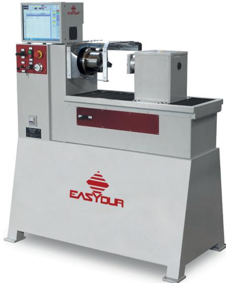
Das Torsiometer ist mit einem PC mit Touch Screen zur Ausführung der Test-Rezepte ausgestattet. Es ist in der Werkbank- und in der freitragenden Bodenausführung erhältlich.
