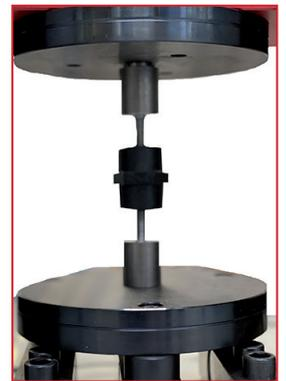
A seconda del tipo di prova da effettuare, lo strumento potrà essere dotato di diversi **accessori**: piattelli, ganci di trazione per molle, pinze per trazione di fili ed **attrezzature speciali** secondo le più svariate specifiche tecniche richieste dagli standard di prova internazionali.
